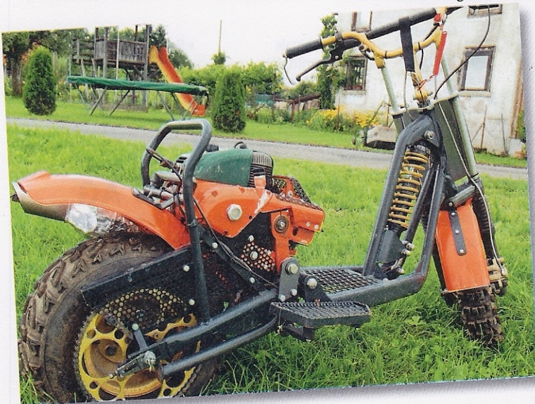
Bei diesem Trotti verwendete der Konstrukteur eine Motorkettensäge als Antrieb.
